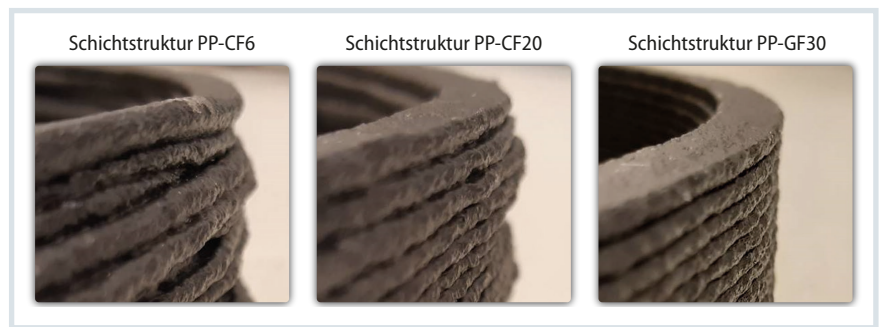
Bild 4. Die Faserlänge und der Fasergehalt beeinflussen die Schichtstabilität und somit auch die Bauteilqualität. © Fraunhofer IWU
